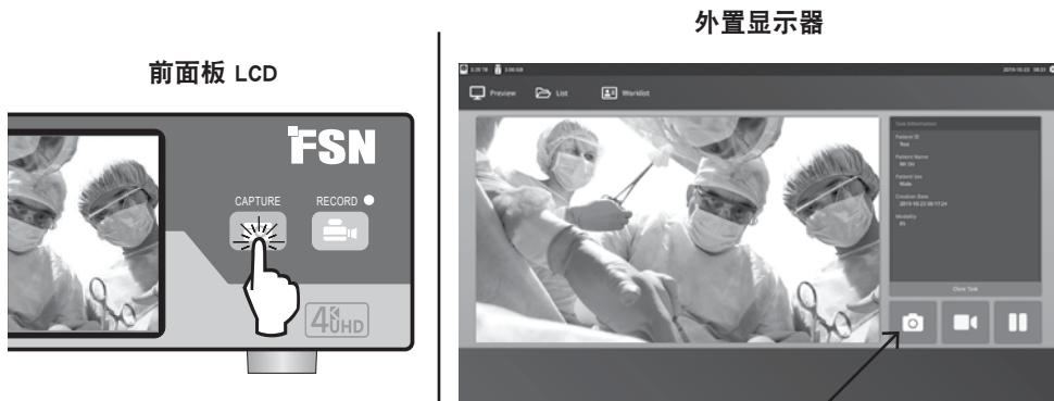
选择相机图标以捕获图像。嘟嘟声表示已完成捕获。捕获的预览将显示 1.5 秒。
