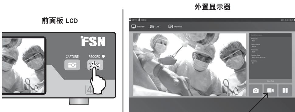
选择录像图标以录制视频。嘟嘟声和红点符号表示正在进行录制。再次选择录像图标以停止录制。
