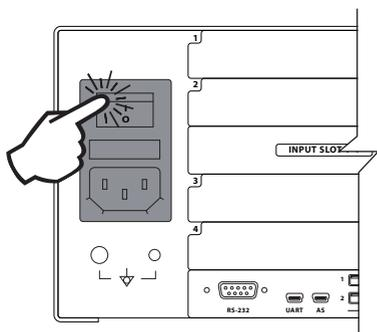
1. Accendere l'alimentazione utilizzando l'interruttore CA sul retro del dispositivo IPS4000.
