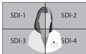
Pour le paramétrage de la vue quadruple SDI, chaque connecteur doit correspondre aux quatre zones d'image illustrées ci-dessus.
