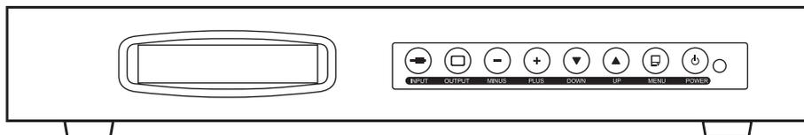
Das 8-Tasten-Bedienfeld auf der Vorderseite ermöglicht die Einstellung verschiedener Anzeigeparameter.
