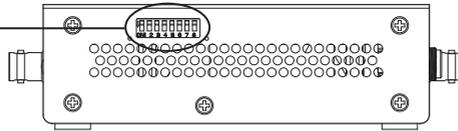
Wenn Schalter 8 ausgeschaltet ist, sind die Schalter 1 - 7 aktiv (manuelle Steuerung). Wenn Schalter 8 eingeschaltet ist, ist die Software-/Wartungssteuerung aktiv.
